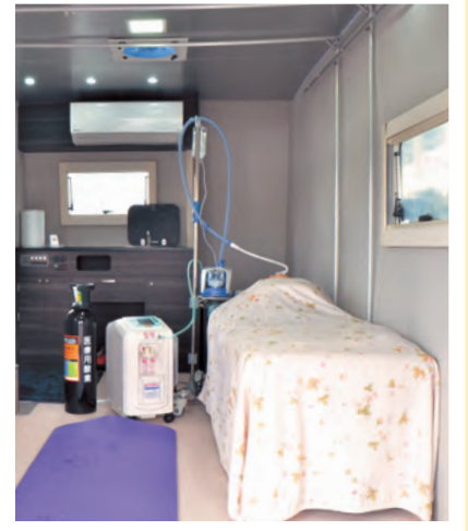
要配慮者用の設備を搭載した 災害支援車両の内部
