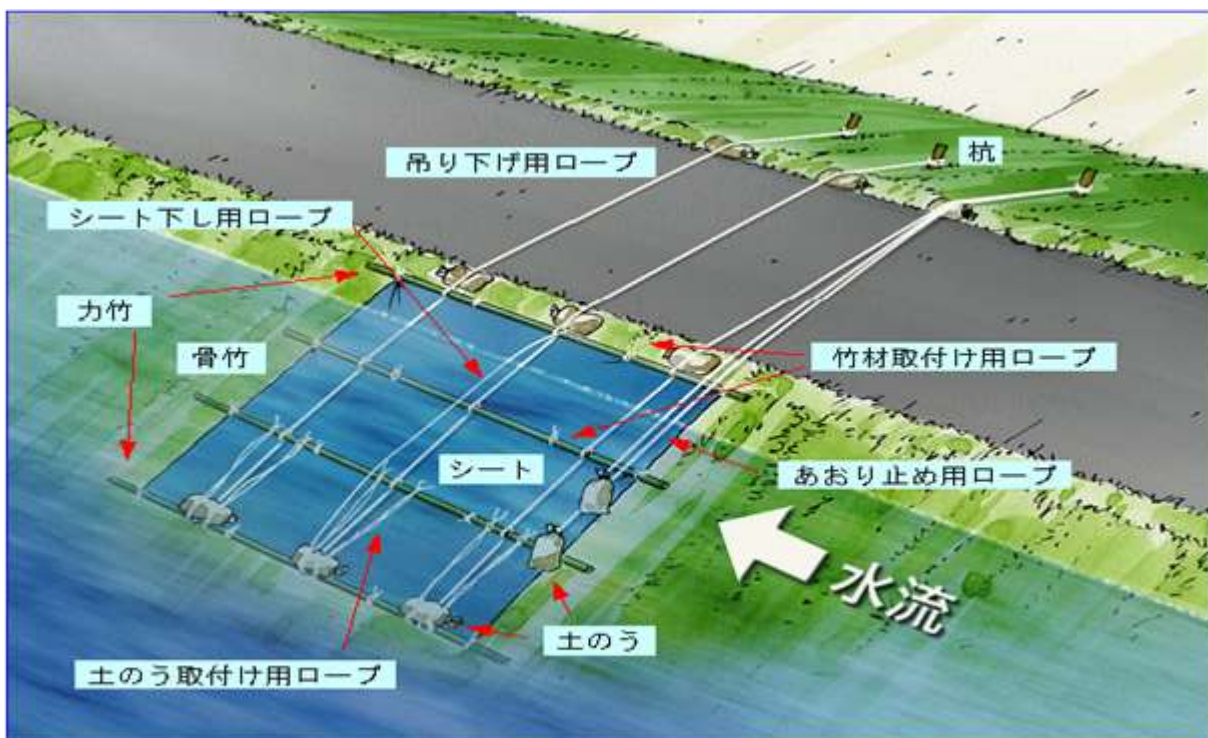
シート張り工法 完成図
